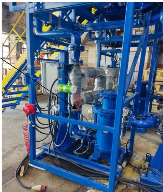
Рисунок 3 - Место установки пломбы поверителя
