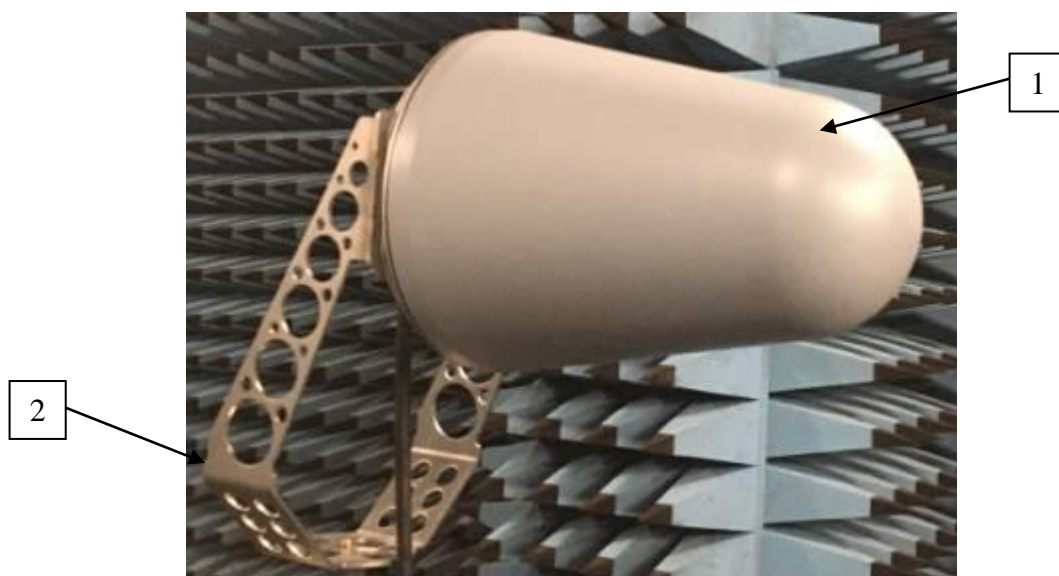
1 – антенна HL050, закрытая радиопрозрачным колпаком 2 – крепление
