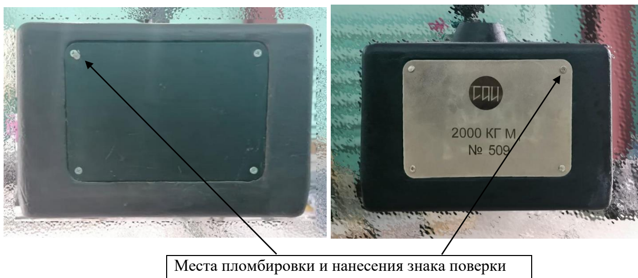
Рисунок 2 – Пример маркировки; схема пломбировки от несанкционированного доступа и место нанесения знака поверки.
