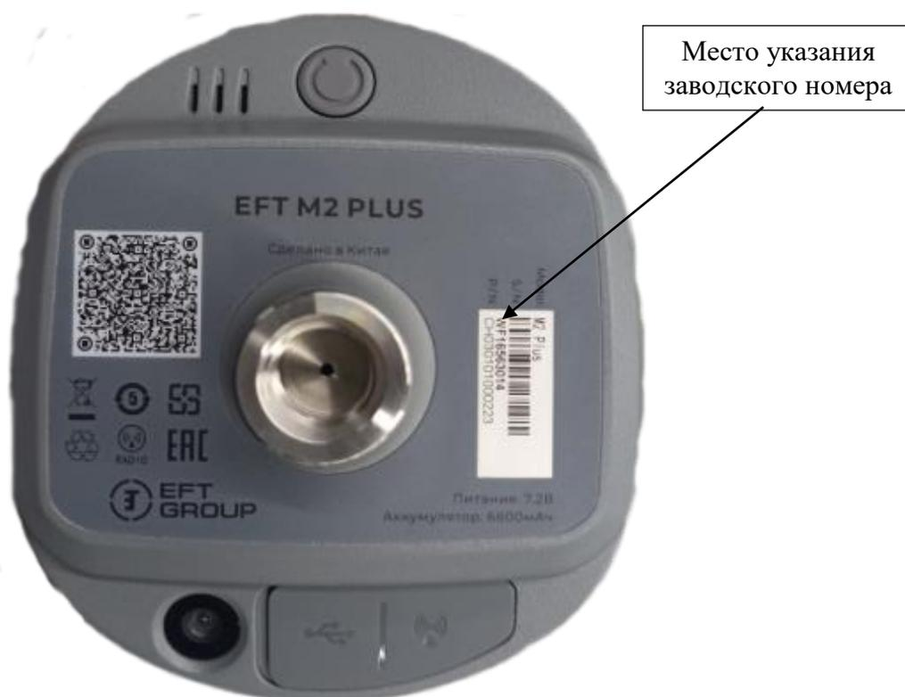
Рисунок 2 – Общий вид маркировочной наклейки с местом указания заводского номера
