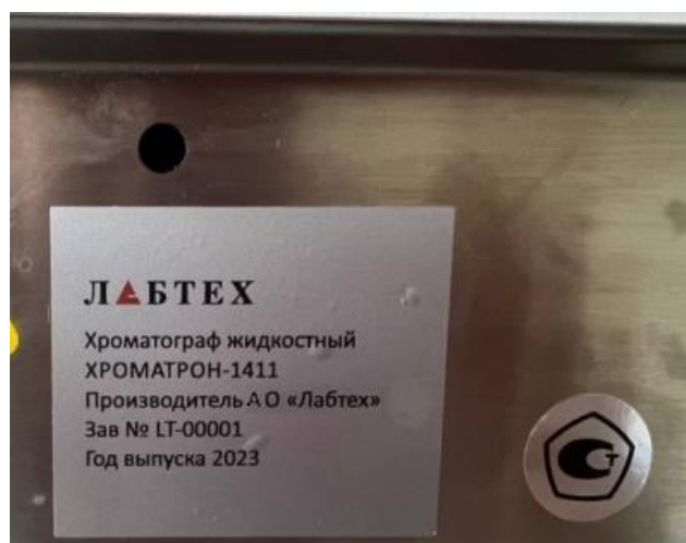
Рисунок 7 - Общий вид информационной таблички (шильдика) с указанием мест нанесения заводского номера и знака утверждения типа
