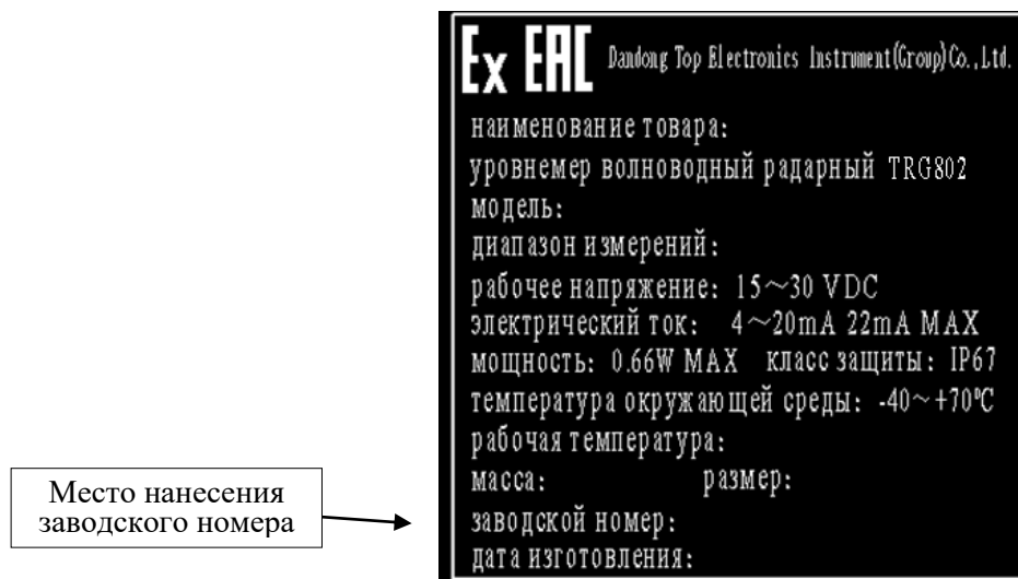
Рисунок 2 – Схема маркировочной таблички
