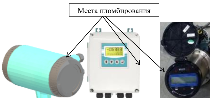
Рисунок 3 – Схема пломбировки от несанкционированного доступа
