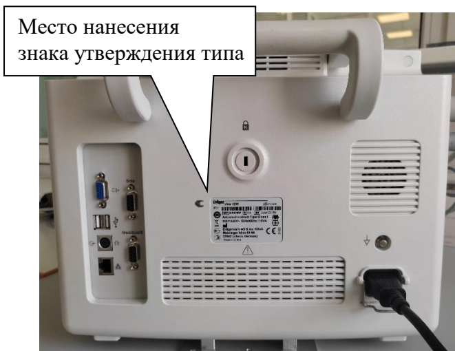
Рисунок 2 – Место нанесения заводских номеров, однозначно идентифицирующих каждый экземпляр средств измерений, и знака утверждения типа.
