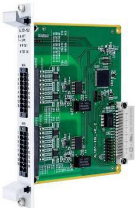
Рисунок 3 – Модуль аналогового ввода сигналов постоянного тока AL101-16I и напряжения AL101-16U
