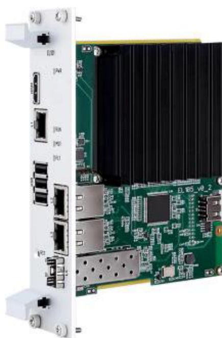
Рисунок 6 – Процессорный модуль CL101 с установленной платой расширения EL105
