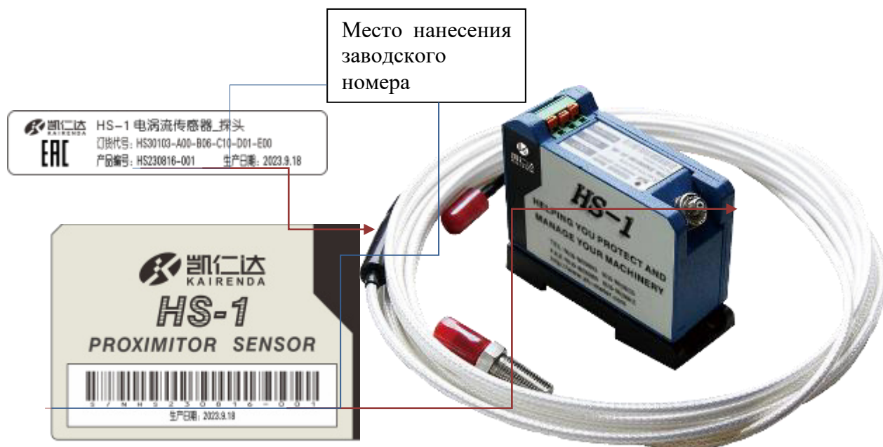
Рисунок 3 – Общий вид преобразователей вихрековых HS-1 из состава системы и места нанесения заводского номера
