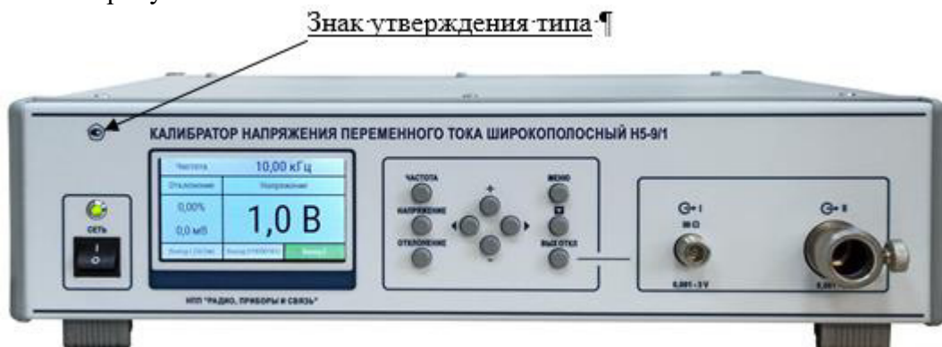
Рисунок 1 – Общий вид калибратора напряжения переменного тока Н5-9/1 и место нанесения знака утверждения типа
