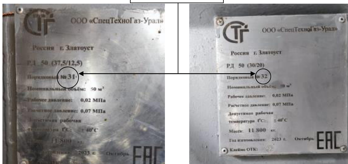
Р и с у н о к 3 – Фотографии металлических шильдов резервуаров с заводскими номерами
