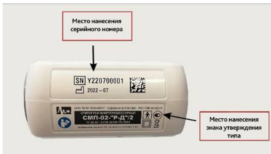
Рисунок 4 – Место нанесения знака утверждения типа и серийного номера в варианте исполнения СМП-02-«Р-Д»/2
