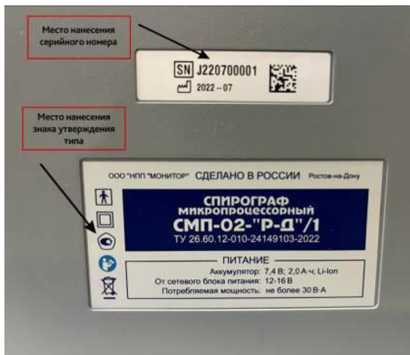
Рисунок 3 – Место нанесения знака утверждения типа и серийного номера в варианте исполнения СМП-02-«Р-Д»/1
