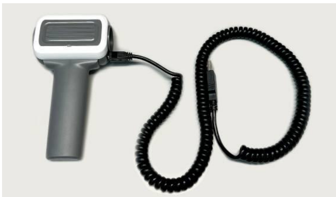
Рисунок 2 – Общий вид спирографа в варианте исполнения СМП-02-«Р-Д»/2
