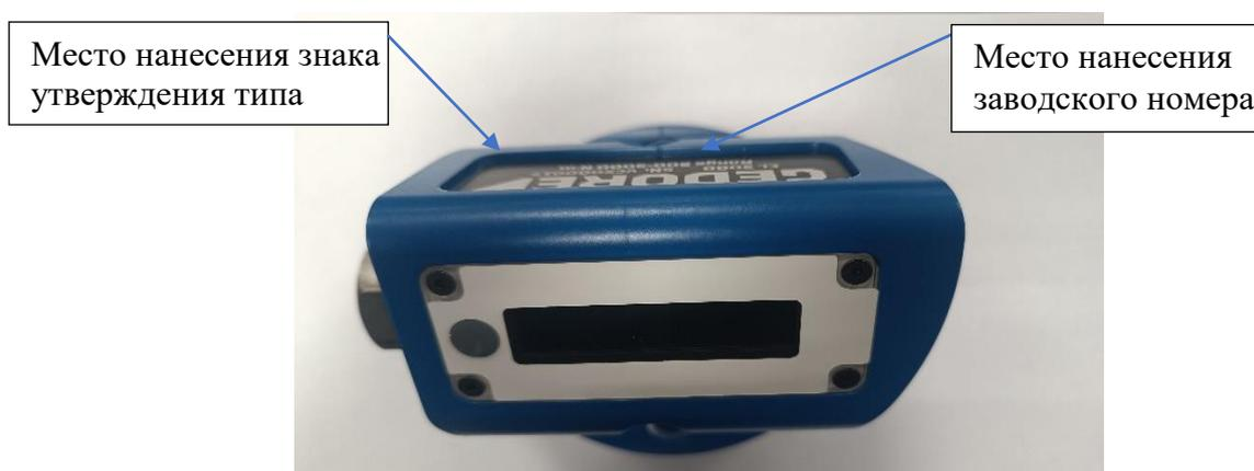
Рисунок 3 - Общий вид измерителей CL1100, CL3000
