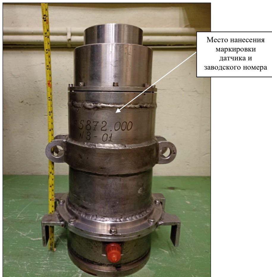
Рисунок 1 – Общий вид датчиков и обозначение мест нанесения маркировки датчика и заводского номера
