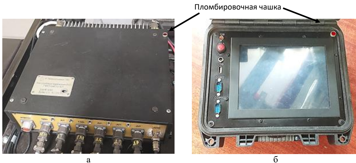
Рисунок 3 – Схема пломбирования от несанкционированного доступа. а- блок управления торможением (БУТ), б - блок управления и индикации (БУИ)
