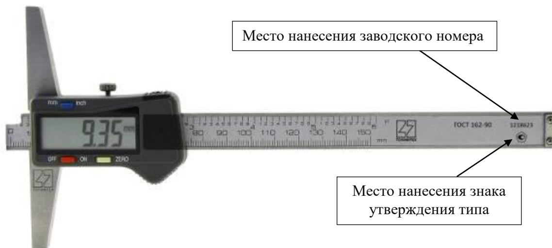
Рисунок 3 – Общий вид штангенглубиномеров модели ШГЦ с указанием мест нанесения заводского номера и знака утверждения типа
