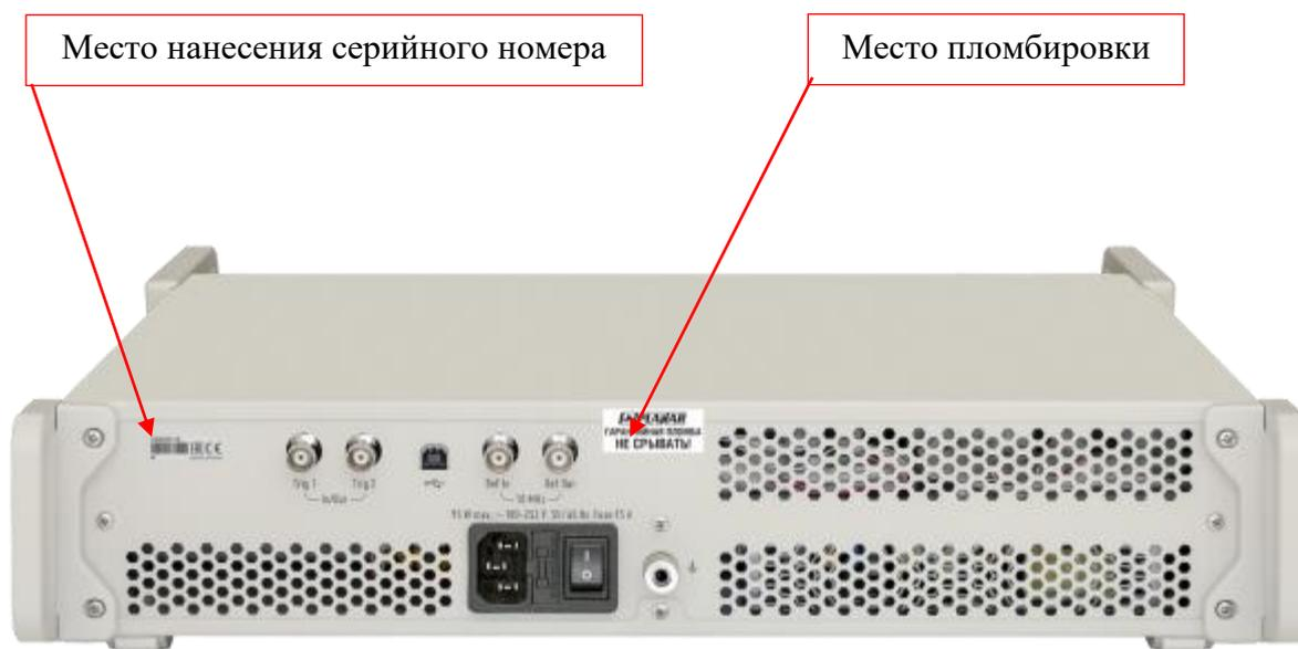
Рисунок 2 – Место нанесения серийного номера, идентифицирующего каждый экземпляр СИ, и схема пломбировки от несанкционированного доступа
