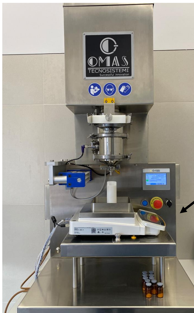
Рисунок 3 – Общий вид блока с питателем для дозирования с малой производительностью с грузоприемным устройством, стрелкой показана боковая панель, на которую нанесена информационная табличка
