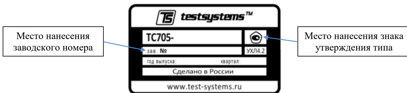
Рисунок 5 – Обозначение мест нанесения знака утверждения типа и заводского номера
