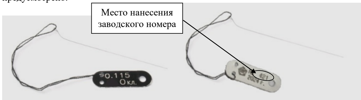
Рисунок 1 – Общий вид проволоочек гладких типа I с указанием места нанесения заводского номера
