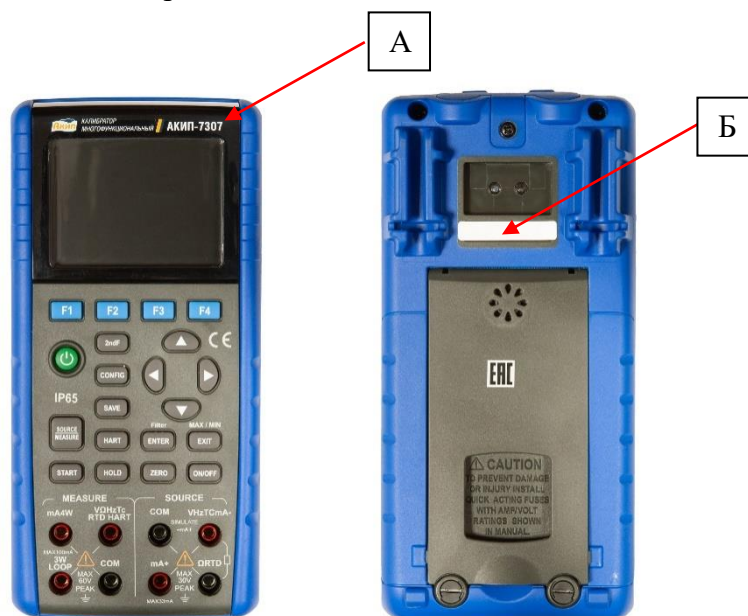
Рисунок 1 – Общий вид калибраторов, места нанесения знака утверждения типа (А) и серийного номера (Б)
