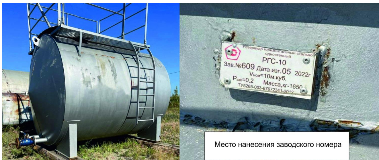
Рисунок 1 – Общий вид резервуара горизонтального стального цилиндрического РГС-10 с указанием места нанесения заводского номера
