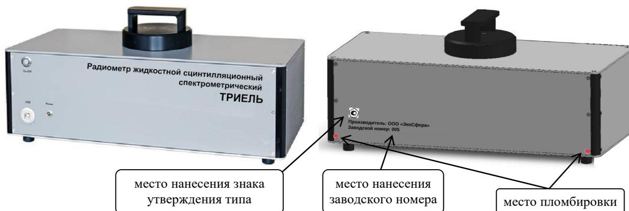
Рисунок 1 - Общий вид радиометров
