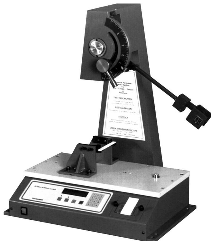
Рисунок 2 - Общий вид копров маятниковых КЭМ-50Р (настольное исполнение)
