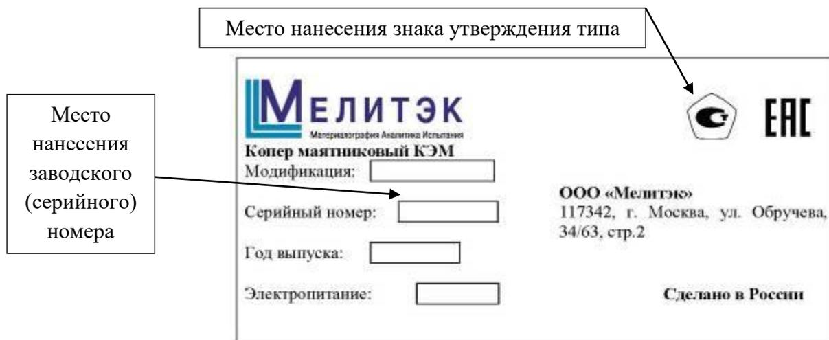
Рисунок 6 – Общий вид маркировочной таблички
