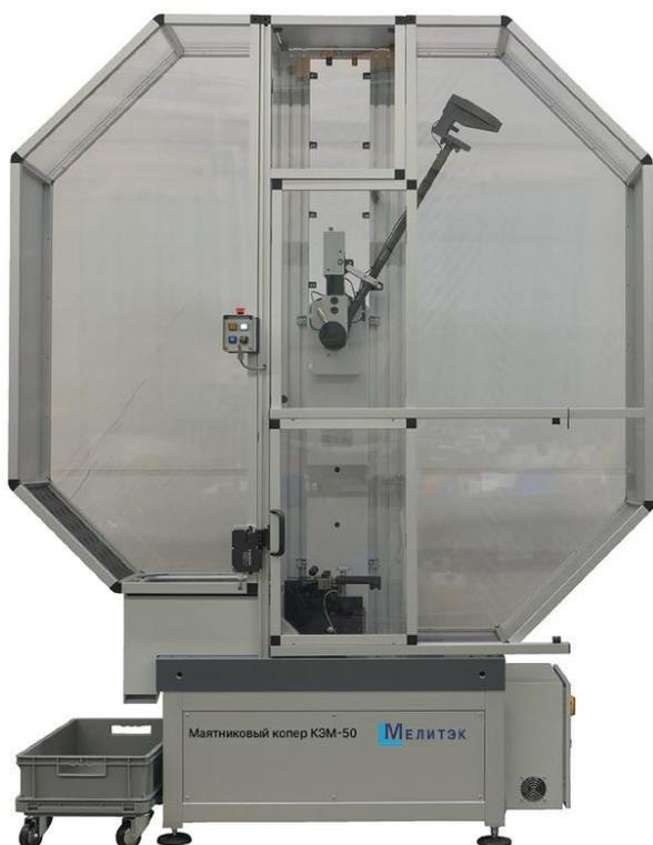
Рисунок 3 - Общий вид копров маятниковых КЭМ-5, КЭМ-15, КЭМ-25, КЭМ-50, КЭМ-75 (напольное исполнение)
