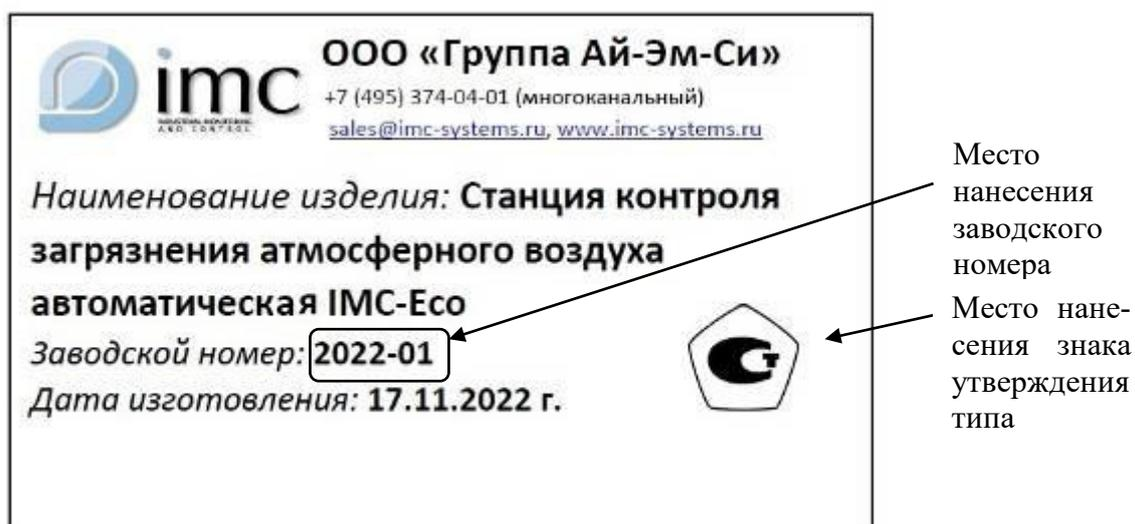
Рисунок 3 – Общий вид шильда (места нанесения заводского номера и знака утверждения типа)
