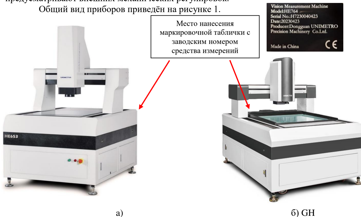
Рисунок 1 – Общий вид микроскопов видеоизмерительных портальных UNIMETRO серий: а) HE, HE PLUS; б) GH
