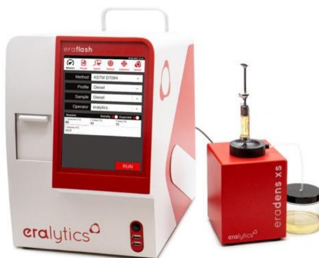
Рисунок 3 – Общий вид плотномера модификации ERADENS XS, подключенного к анализатору производства eralytics GmbH
