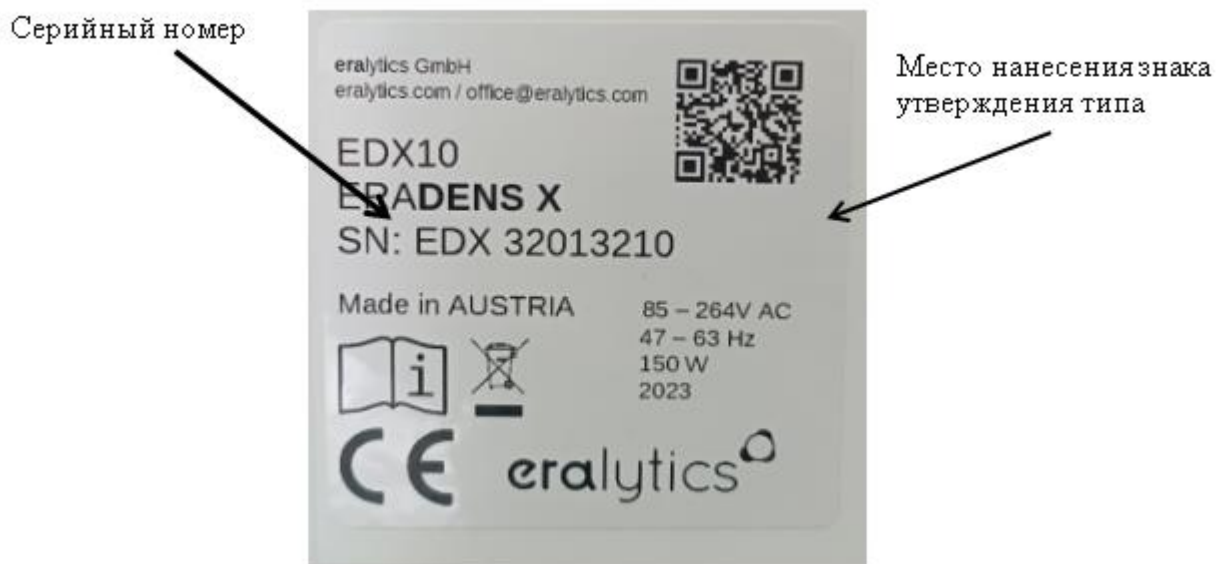
Рисунок 5 – Табличка с местами нанесения серийного номера и знака утверждения типа на плотномер модификации ERADENS X
