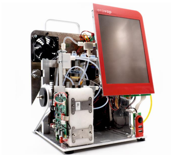
Рисунок 4 – Общий вид плотномера модификации ERADENS XS, встроенного в анализатор производства eralytics GmbH
