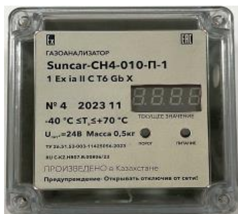
Рисунок 7 – Общий вид газоанализаторов Suncar-XX-XXX-X-X во взрывозащищенном исполнении, в корпусе из пластика. Исполнение в корпусе «П»
