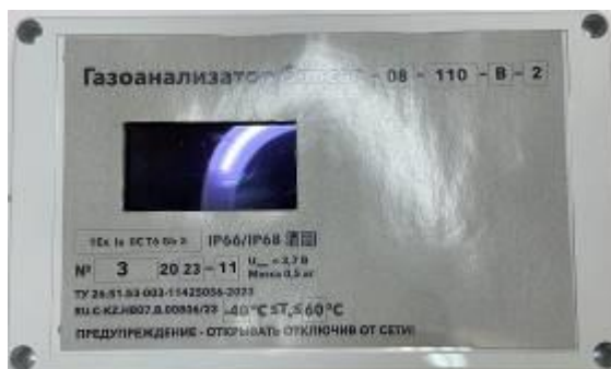
Рисунок 1 – Общий вид газоанализаторов Suncar-XX-XXX-X-X во взрывозащищенном исполнении, в корпусе из алюминиевого сплава с двумя отсеками. Исполнение в корпусе «Г»
