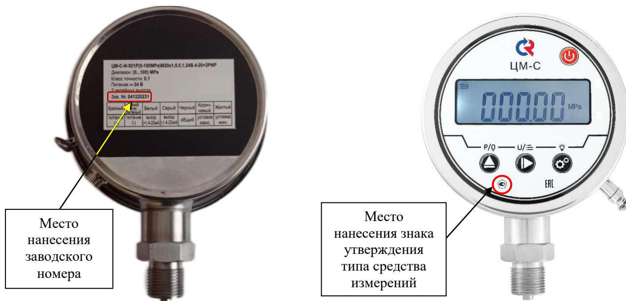
Рисунок 3 – Места нанесения заводского номера и знака утверждения типа средства измерений
