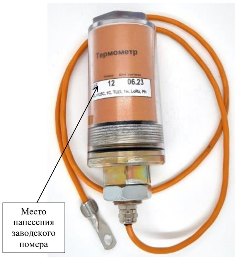
е) исполнение термошупа ТТЦ5 (в виде гильзы под винт)
