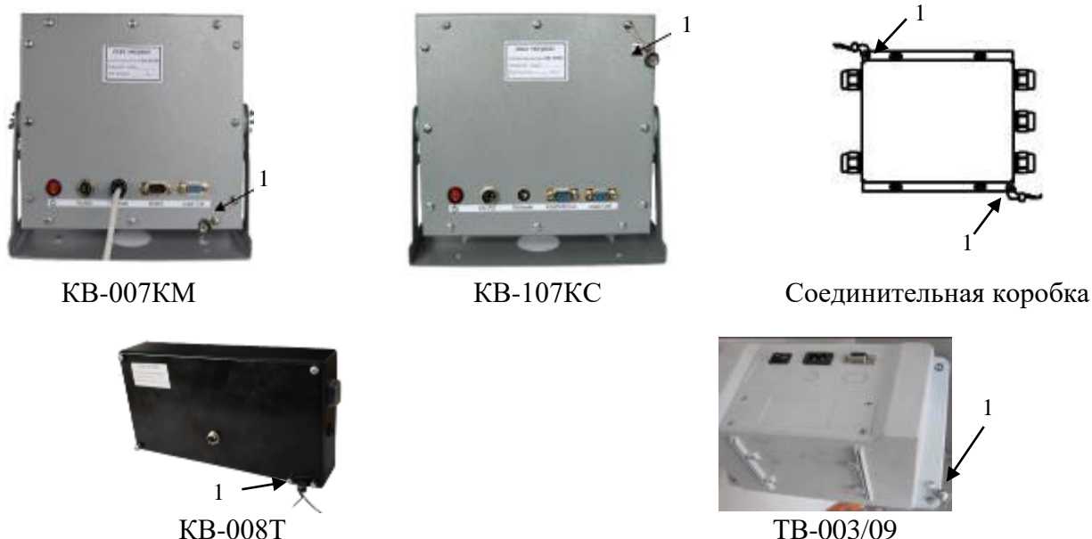
Рисунок 4 – Схема пломбировки приборов весоизмерительных (1 – свинцовая, пластиковая или мастичная пломба)
