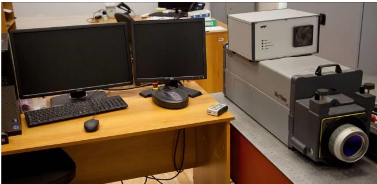
Рисунок 2 – Внешний вид интерферометров Zygo VeriFire Модификации: а) АТ, б) QPZ, в) XPZ.
