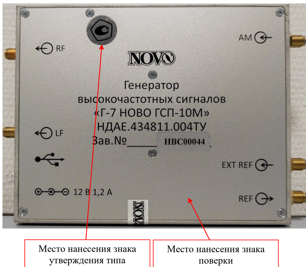
Рисунок 3 – Общий вид генераторов, верхняя панель
