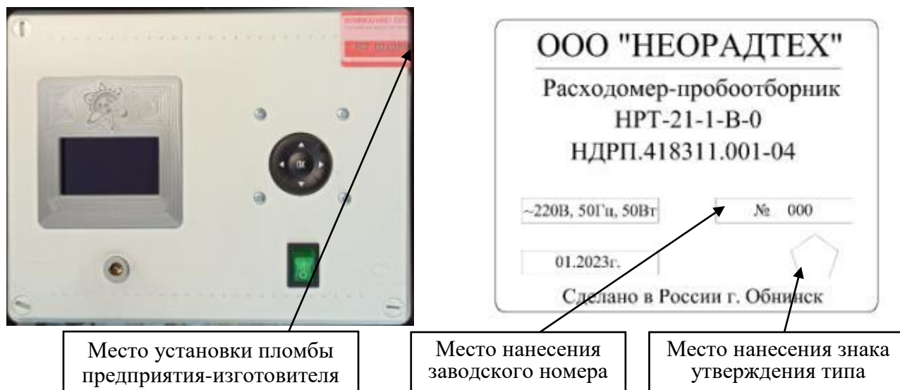
Рисунок 2 – Схема пломбировки и общий вид (схема) маркировочной таблички
