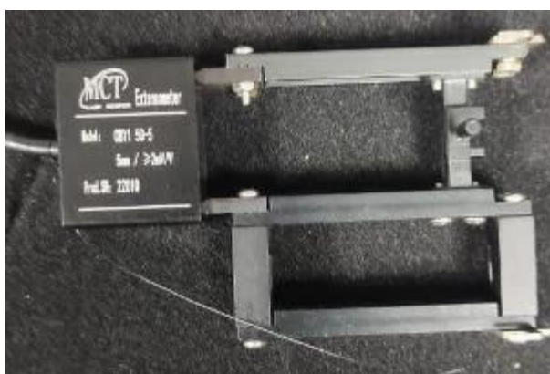
Рисунок 2 – Общий вид экстензометров типов СВУ1 25-5 или СВУ1 50-5
