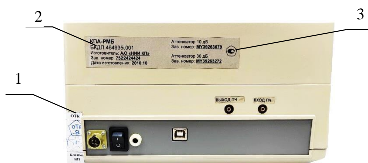
Рисунок 2 – Общий вид задней панели блока ППЧ 1 – места установки пломбы; 2 – место нанесения заводского номера; 3 – место нанесения знака утверждения типа
