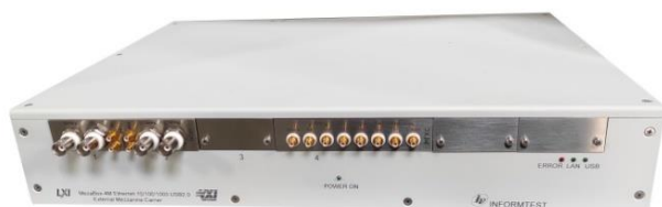
Рисунок 8 - носитель мезонинов MezaBOX-4M LXI с установленными в нем мезонинами МГКС и ОСЦ5
