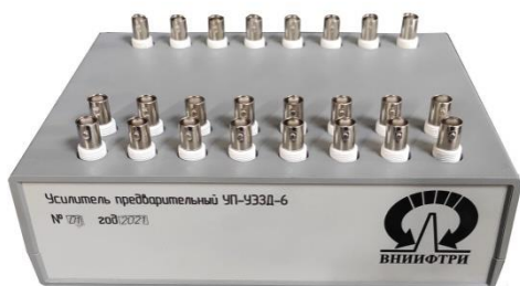
Рисунок 2 - усилитель предварительный УП-УЭЗД-6
