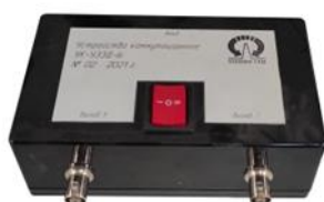
Рисунок 4 - устройство коммутационное УК-УЭЗД-6
