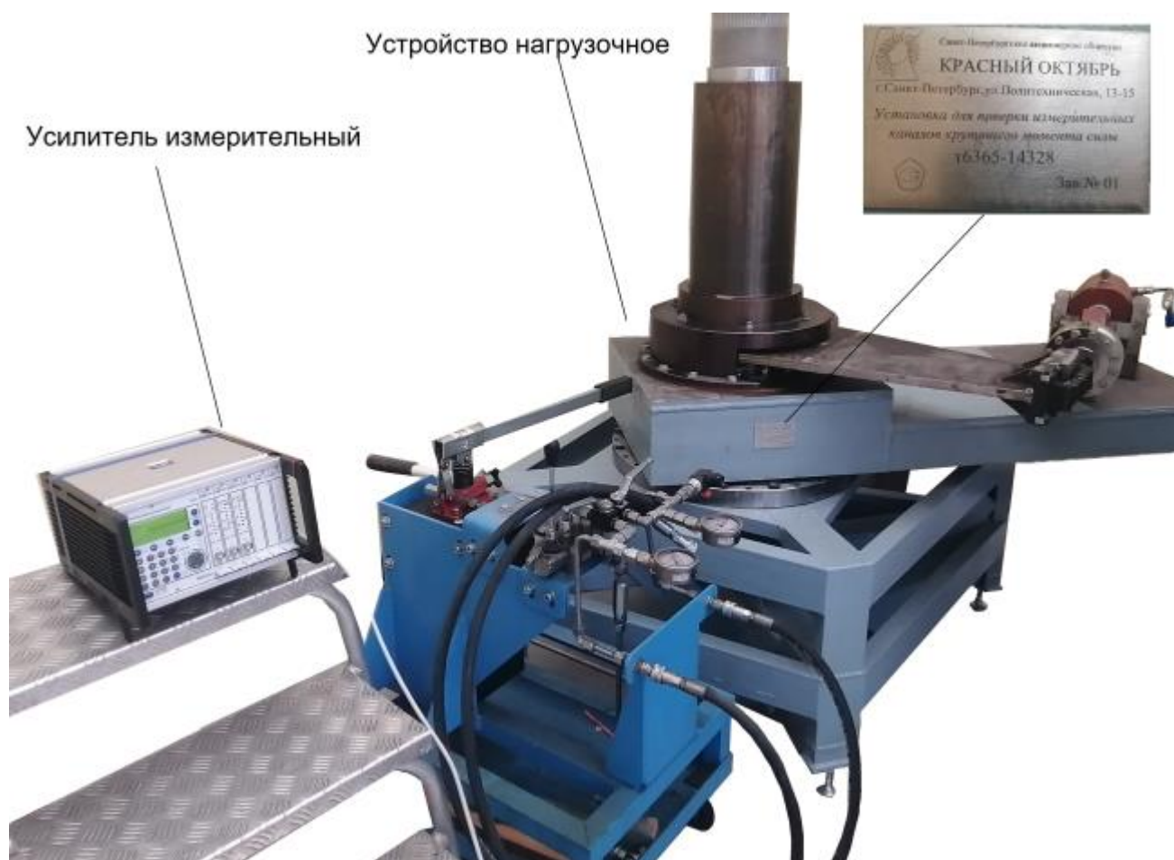
Рисунок 1 – Общий вид установки для поверки измерительных каналов крутящего момента силы Т6365-14328
