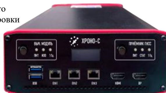
Рисунок 2 – Аппаратура синхронизации и сравнения шкал времени XRONO-C.RSHV и XRONO-C
