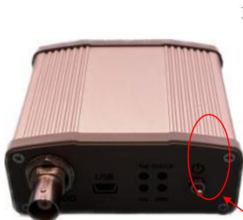
Рисунок 1 – Аппаратура синхронизации и сравнения шкал времени XRONO-C.GNSS
