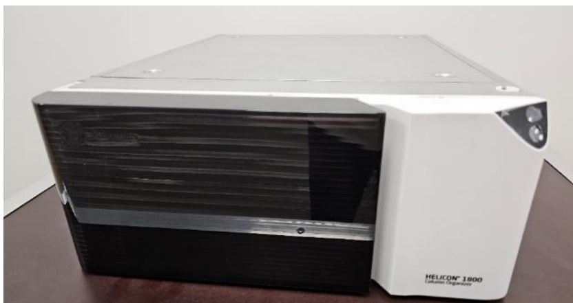
Рисунок 5 – Общий вид блоков термостатирования разделительных колонок моделей HELICON 1800 SO и HELICON 1800 SO II
