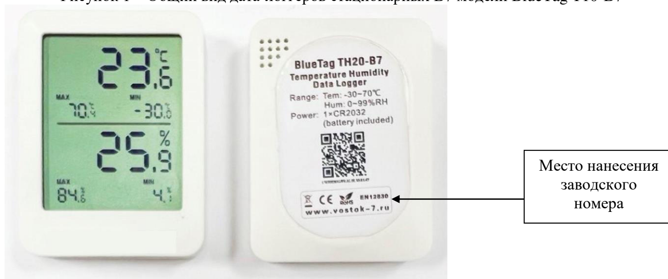
Рисунок 1 – Общий вид дата-логгеров стационарных В7 модели BlueTag T10-B7
