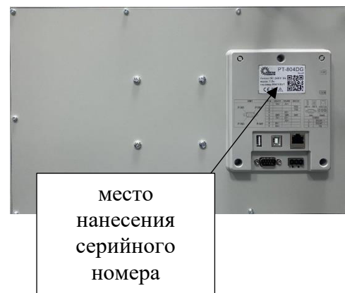
Рисунок 2 – вид оборотной стороны панели и место нанесения серийного номера
