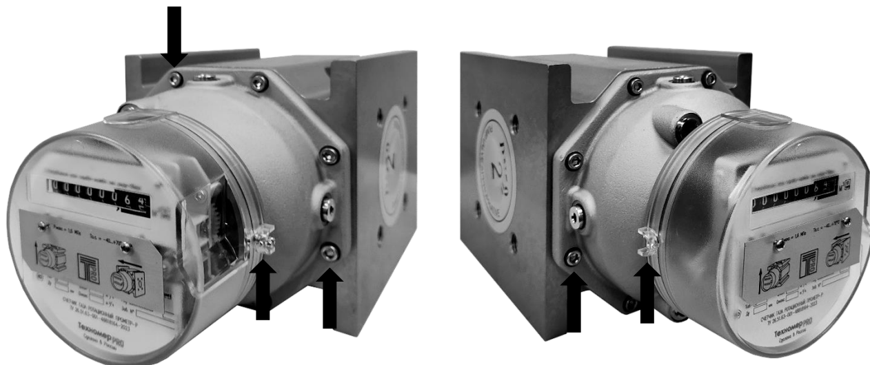
Рисунок 3 – Схема пломбировки от несанкционированного доступа и место нанесения знака поверки
