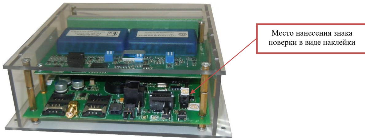
Рисунок 5 - Фотография общего вида с указанием места нанесения знака поверки в виде наклейки для исключения доступа к разъёму программирования автономных контроллеров КУТ300-АК1, КУТ300-АК2 и КУТ300-АК3.
