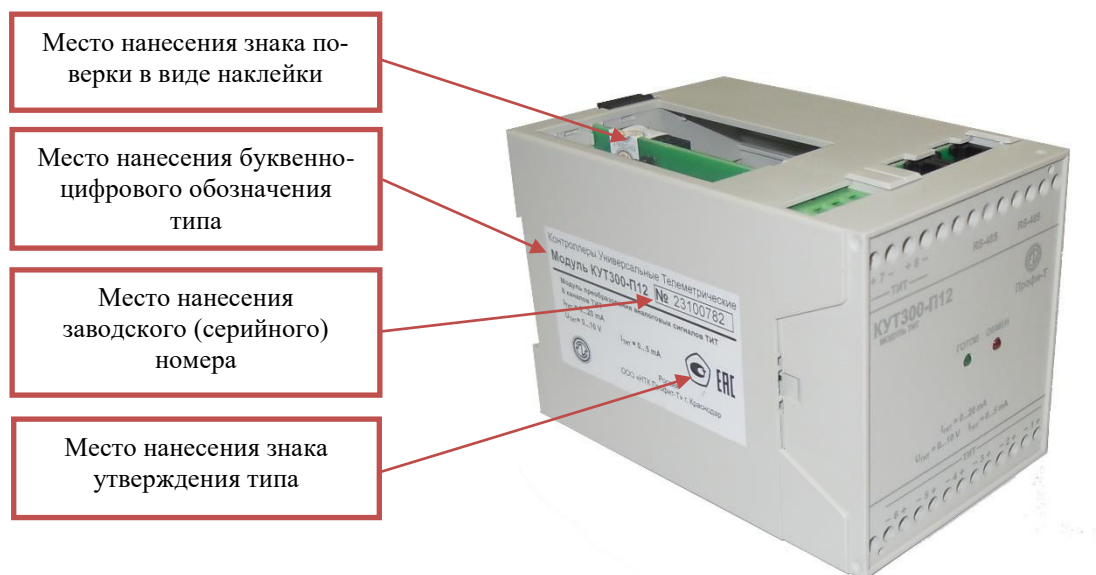
Рисунок 2 - Фотография общего вида с указанием мест нанесения заводского (серийного) номера, буквенно-цифрового обозначения типа, однозначно идентифицирующих каждый модуль КУТ300-П12, входящий в состав промышленного контроллера КУТ300-ПК, знака утверждения типа и знака поверки в виде наклейки для исключения доступа к разъёму программирования модуля
