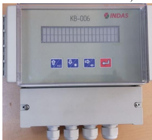
а) Общий вид весов, б) Внешний вид контроллера КВ-006, в) шкаф весового прибора со встроенным преобразователем МВ-110
