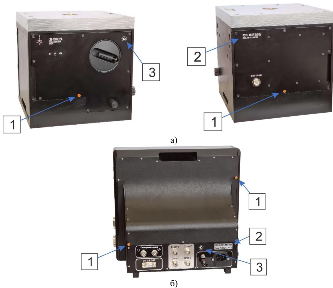
Рисунок 3–Расположение пломб (1), мест нанесения заводского номера (2) и знака утверждения типа (3) а) – поворотный стол; б) – блок управления.
