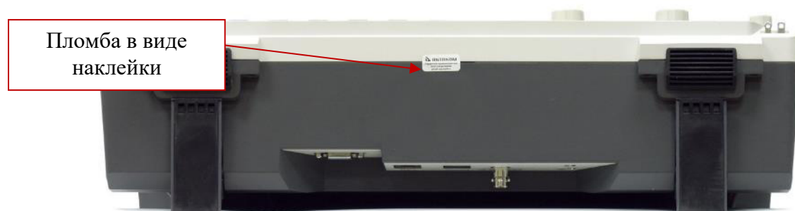
Рисунок 3 – Место ограничения доступа к местам настройки (регулировки) (вид снизу)
