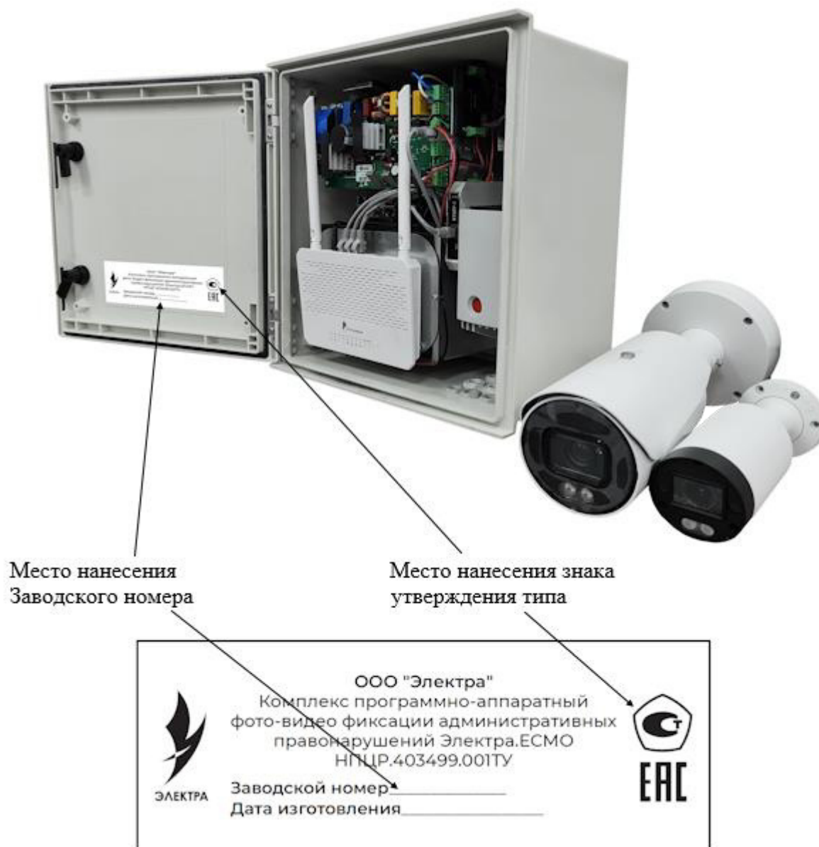
Рисунок 3 – Место нанесение заводского номера и знака утверждения типа
