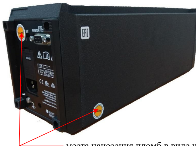
Рисунок 2 – Схема пломбировки от несанкционированного доступа места нанесения пломб в виде наклеек
