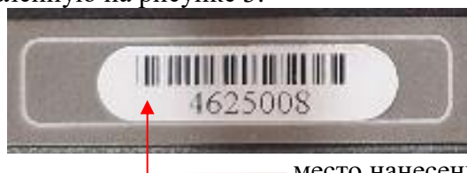
Рисунок 3 - Общий вид маркировочной наклейки, место нанесения заводского номера
